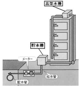
貯水槽の点検・清掃を定期的に行わないと、水槽内の汚れや本体の腐食による濁りや異臭、漏水の原因となります。貯水槽の管理は設置者の責任であり、法令で年1回の清掃が義務付けられています。清浄な水をお使いいただくためにも年に1回以上の清掃・点検を行ってください。
