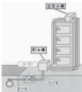
貯水槽の点検・清掃を定期的に行わないと、水槽内の汚れや本体の腐食による濁りや異臭、漏水の原因となります。貯水槽の管理は設置者の責
