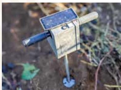
硬土計で土の硬さを測定している様子
